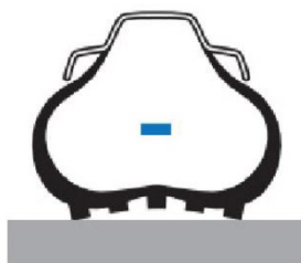
Presión de aire demasiado baja
